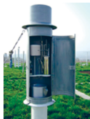
▲ Fig. 3.39 Pluviograf, aparat pentru înregistrarea precipitațiilor atmosferice
