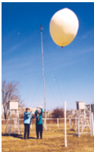
▲ Fig. 3.56 Lansarea unei radiosonde meteorologice
