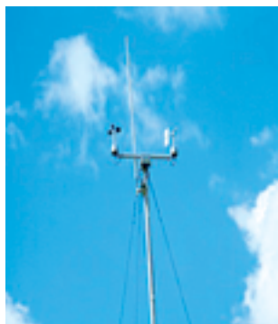
▲ Fig. 3.20 Măsurarea automată a direcției și vitezei vântului
