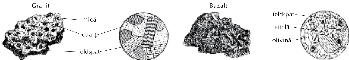
▼ Fig. 2.8 Compoziția mineralogică a granitului și a bazaltului
