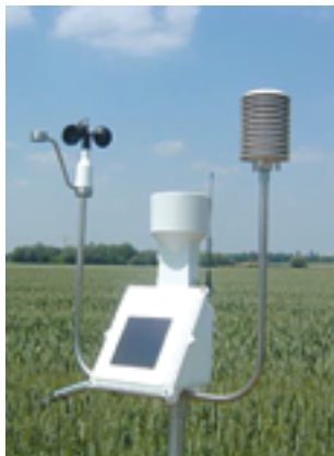
▲ Fig. 3.57 Stație meteorologică automată pentru fermieri
