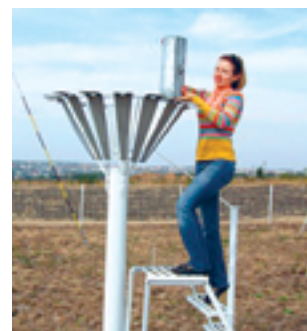
▲ Fig. 3.38 Pluviometru, instrument pentru măsurarea cantității de precipitații
