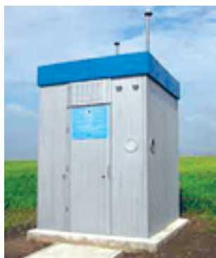
▲ Fig. 3.82 Post pentru monitorizarea calității aerului
