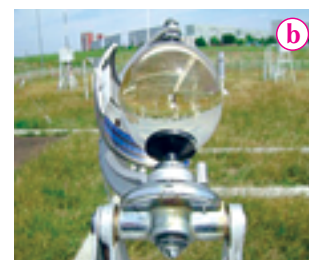
▲ Fig. 3.6 Aparate actinometrice: a) piranometru, aparat pentru măsurarea radiației solare; b) heliograf, aparat pentru înregistrarea duratei strălucirii Soarelui.
