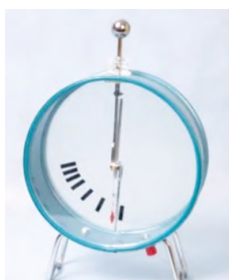
Рисунок 2. Электроскоп со стрелкой и шкалой (электрометр)
