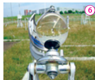
▲ Рис. 3.6 Актинометрические устройства: а) пиранометр – прибор для измерения солнечной радиации б) гелиограф – прибор для регистрации продолжительности яркости Солнца
