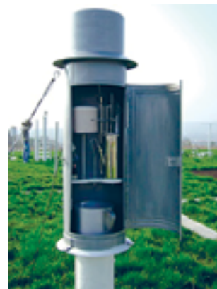
▲ Рис. 3.39 Плювиограф, прибор для регистрации атмосферных осадков
