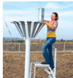
▲ Рис. 3.38 Плювиометр, прибор для измерения количества осадков
