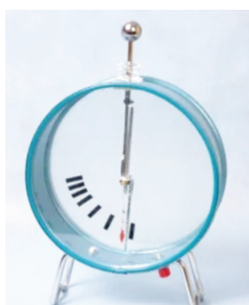
Figura 2. Electroskop cu ac și cu cadran (electrometru)
